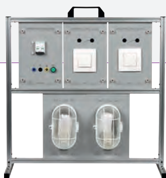
Etude d'un circuit double allumage avec interrupteurs
