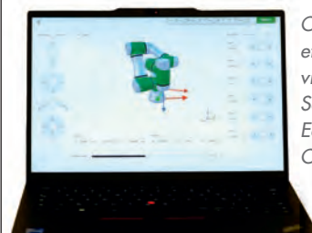
Apprentissage de positions et trajectoires par entraînement libre
