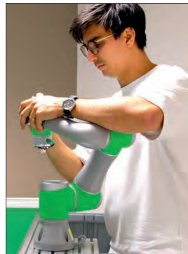
Apprentissage de positions et trajectoires par entraînement libre
