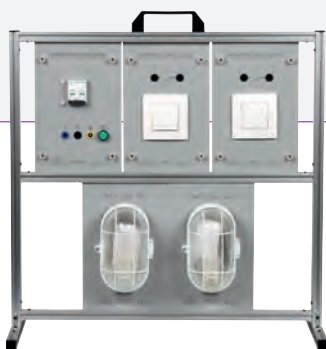
Etude d'un circuit double allumage avec interrupteurs
