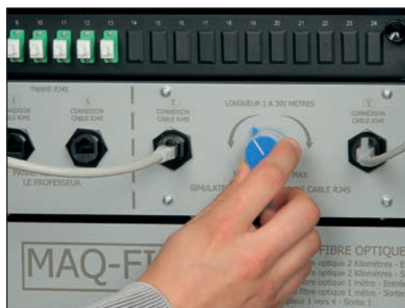
Potentiomètre de simulation de longueur de câble RJ45
