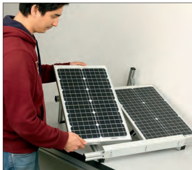
Installation des panneaux : le châssis peut-être basculé pour simuler une pose sur toiture
