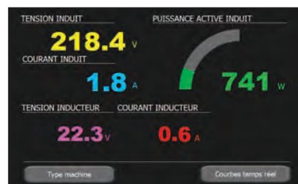
Visualisation pour machine à courant continu
