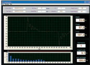
Courant pic - THD - Spectre des harmoniques
