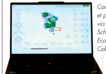
Apprentissage de positions et trajectoires par entraînement libre
