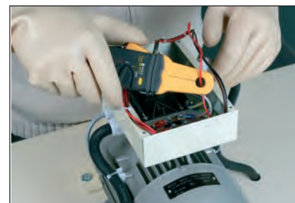
Recherche de panne en condition réelle sur le bornier moteur.
