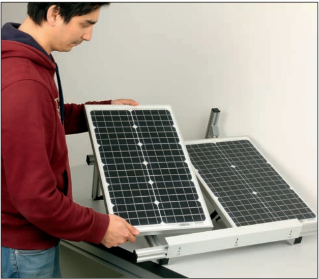
Installation des panneaux : le châssis peut-être basculé pour simuler une pose sur toiture
