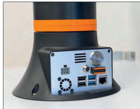
Electronique, alimentation et ports com centralisés dans le pied du robot
