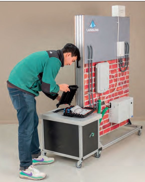
Accès aisé au BPEO de rue situé sous une trappe dans un boîtier technique simulant un regard télécom.
