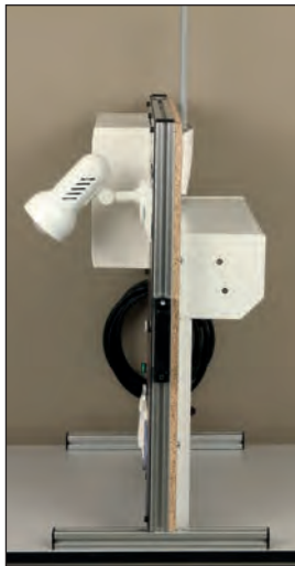
Le micromodule est protégé derrière une plaque transparente qui recouvre la connectique et protège des contacts électriques. Seul le bouton de programmation reste accessible sans démontage.
