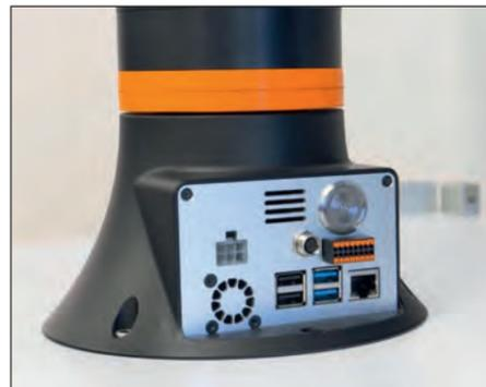
Électronique, alimentation et ports centralisés dans le pied du robot
