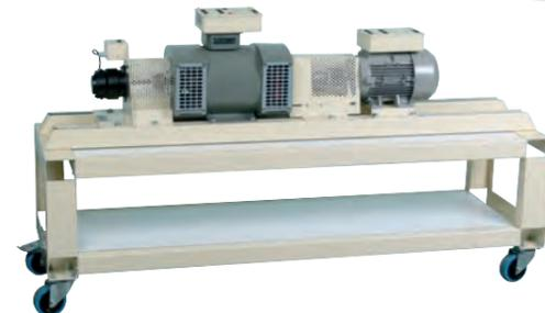
Ensemble de modules (H-250mm) et de machines tournantes permettant l'étude de la synchronisation d'un alternateur 1500W au réseau électrique 3 x 400V.
