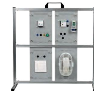
Etude d'un circuit d'allumage avec contacteur crépusculaire
