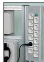
Prises à l'arrière du pupitre pour raccordement des modules
