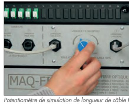
Potentiomètre de simulation de longueur de câble RJ45
