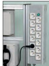
Prises à l'arrière du pupitre pour raccordement des modules
