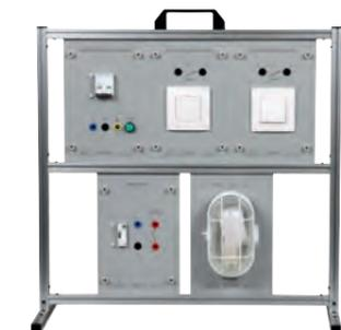
Etude d'un circuit d'allumage avec minuterie type cage d'escalier
