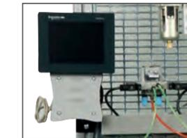
La version communicante est équipée d'un IHM et d'un switch Wifi pour permettre la supervision de l'ensemble de la maquette.
