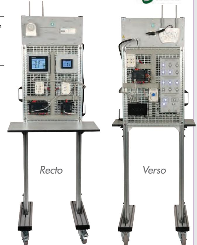
ETUDE D'UN AUTOMATE SIEMENS® ET DE LA SUPERVISION ECLAIRAGE D'UNE ZONE COMMERCIALE
