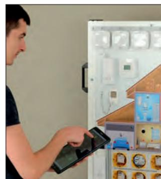
L'ensemble des modules émetteur/récepteur radio Delta Dore et les interrupteurs type habitat sont intégrés sur la face avant.
