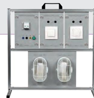
Etude d'un circuit double allumage avec interrupteurs
