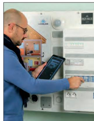
L'ensemble des interrupteurs type habitat et MH paramétrables sont intégrés sur la face avant. Une plaque translucide sur l'adaptateur universel, recouvre la connectique et protège des contacts électriques.
