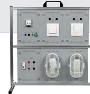
Etude d'un circuit d'allumage avec bouton poussoir et télérupteur
