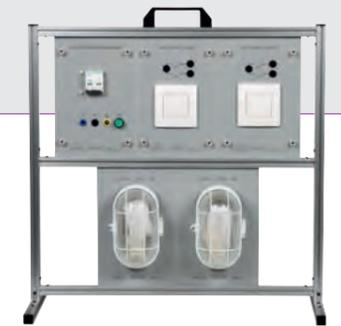
Etude d'un circuit d'allumage avec interrupteurs va et vient
