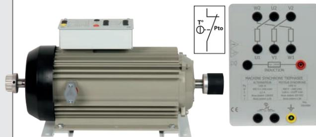
Fonctionne en moteur synchrone et en alternateur triphasé. Equipé de pôles Leblanc.
