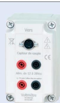
Le capteur de couple sans balais est raccordé à la prise DIN de l'interface INTER-SB, laquelle est alimentée par une source continue extérieure 12 à 28Vcc. Le signal de mesure 0 à 5V (5V pour le couple nominal) est l'image du couple mécanique en Nm. Un voltmètre convenablement étalonné affichera directement le couple en Nm.
