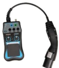
Livrée avec un testeur de borne de recharge
