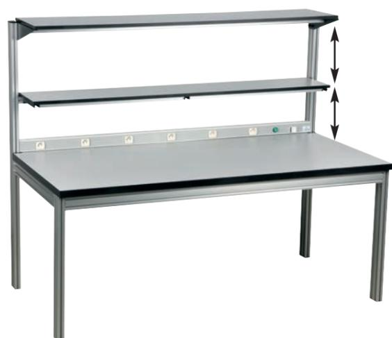
Grande stabilité, aucun mouvement de translation grâce aux profilés aluminium horizontaux de section 80x40mm ainsi qu'aux 4 pieds 40x40mm avec tampons plastiques.
