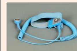
Bracelet antistatique en tissu ajustable conçu pour empêcher l'accumulation d'électricité statique sur son corps. Fourni avec un cordon extensible (0,5m -2,5mm). Le cordon est muni d'une résistance de 2M Ohms. Raccordement au moyen d'un goujon de 10mm.
