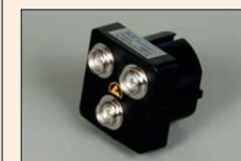
Permet de raccorder à la terre de façon simple et sûre via 3 goujons de 10mm. Il peut être connecté sur une prise 2P+T de type E (européenne) ou de type F (SCHUKO)
