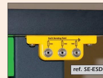
Conçu pour la fixation sous un plan de travail. Il permet de raccorder les utilisateurs et autres éléments de la zone antistatique à la terre. Le support de 3 goujons de 10mm est muni d'une résistance de 1M Ohm.
