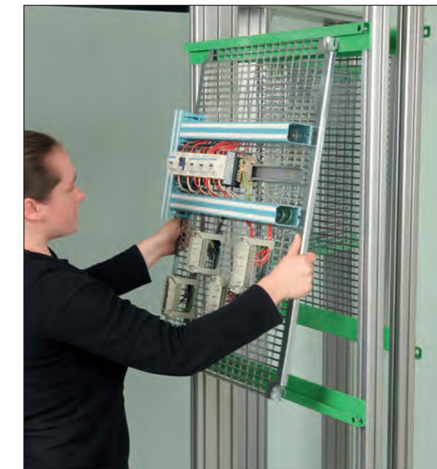
Système de fixation rapide des supports.
