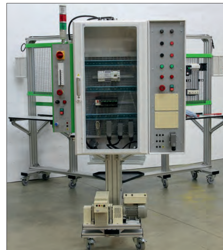
Armoire d'essai avec pupitre élève, pupitre d'alimentation générale, et banc moteur 300W
