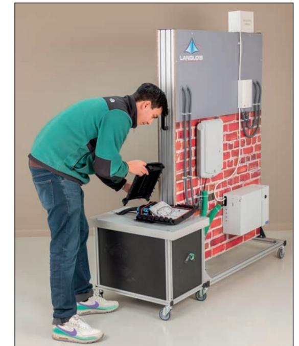
Accès aisé au BPEO de rue situé sous une trappe dans un boîtier technique simulant un regard télécom.
