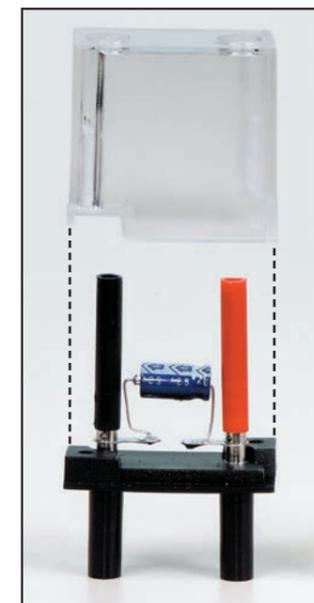
Pour remplacer le composant, il suffit de dévisser les deux vis qui maintiennent le capot, dessouder le composant des deux cosses métalliques, et ressouder un composant neuf.
