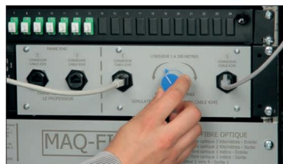
Potentiomètre de simulation de longueur de câble RJ45
