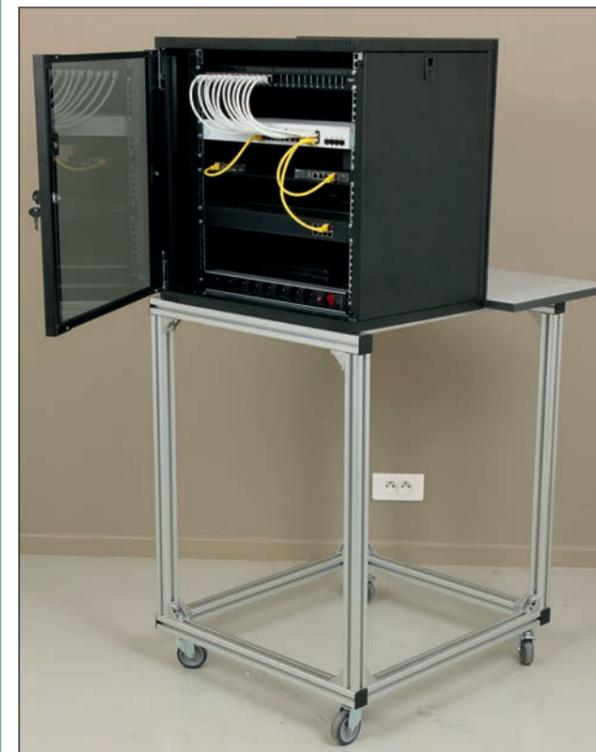
Système complet permettant de simuler le déploiement d'un réseau informatique, téléphonique et de vidéo surveillance d'une petite entreprise. Il permet la formation aux infrastructures de réseaux en fonction d'un cahier des charges client ainsi que l'application des notions d'administration réseaux et de cybersécurité.
