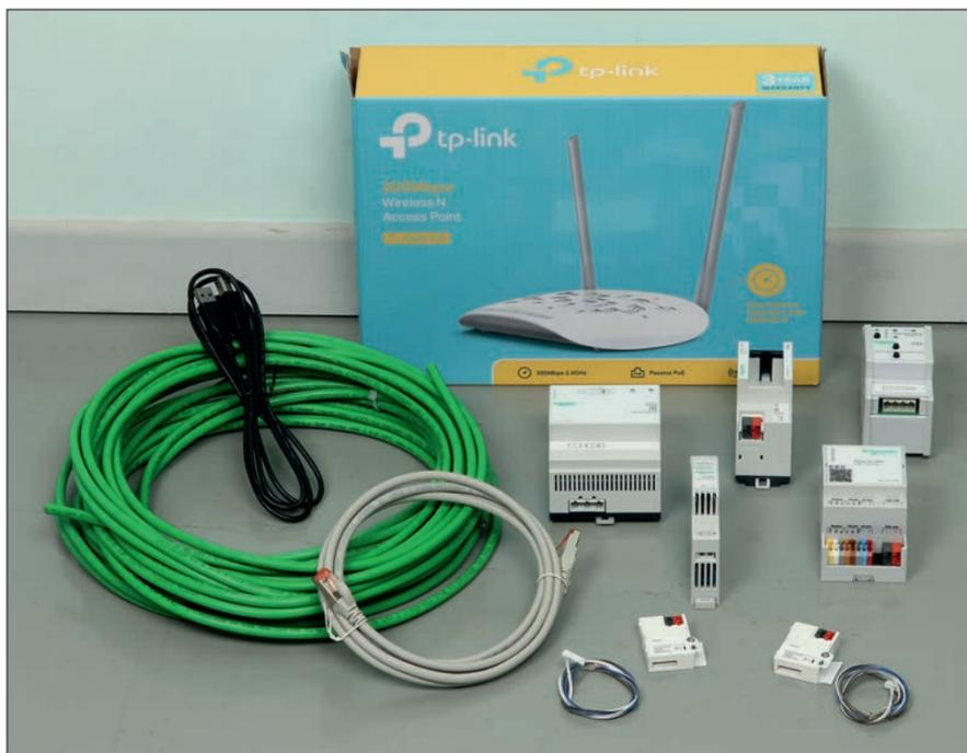
Ce kit passerelle KNX est le moyen le plus simple de connecter une installation standard non communicante pour prendre le contrôle local et distant via le réseau KNX. Votre installation est alors pilotable via Smartphone/ tablette et peut s'enrichir de divers objets connectés.
