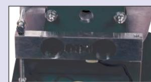
Les machines GE90 et FR90 sont équipées d'un capteur de couple. Il s'agit d'une structure en alu avec jauge de contrainte en pont de Wheatstone. Sensibilité : 10mV/Nm. Alimentation : 6VDC. Couple max : 1Nm.
