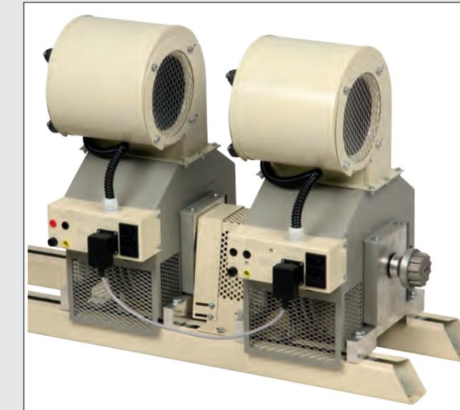
Comme les freins à poudre des autres gammes, un simple courant continu sous une tension faible autour de 14V crée un couple de freinage constant pour toutes les vitesses entre 0 et 1500 t/min.
