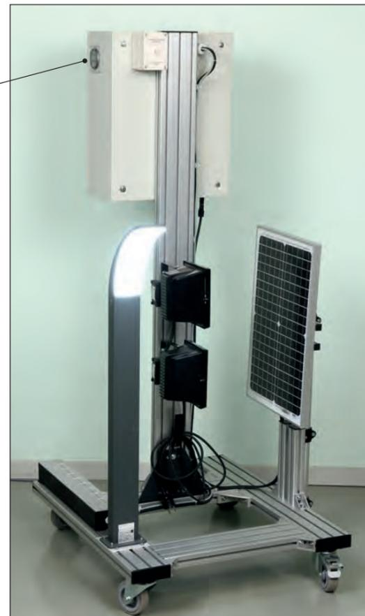
Panneau monocristalin 30Wc pivotant et orientable pour utilisation intérieure avec les 2 projecteurs fournis, extérieure avec une source solaire naturelle.
