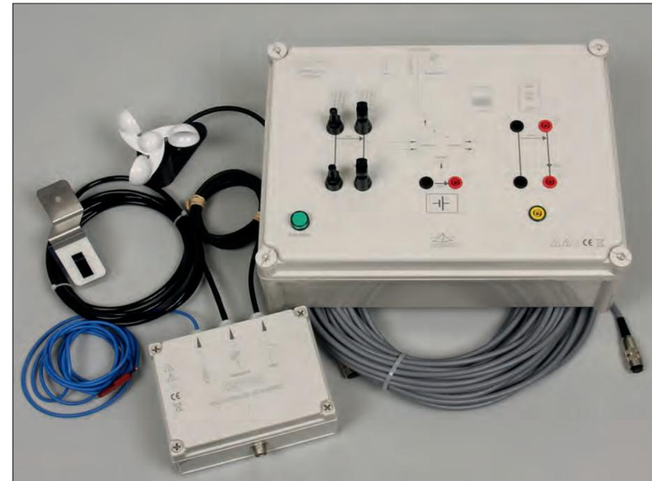
Ensemble de capteurs, interfaces et logiciel permettant la surveillance en temps réel, des données d'une installation photovoltaïque.
