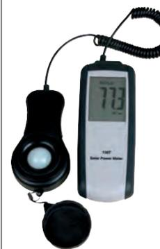
Le pyranomètre mesure la puissance du rayonnement solaire en W par m² : W/m²
