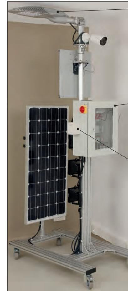
Panneau monocristalin 90Wc pivotant et orientable pour utilisation intérieure avec les 2 projecteurs fournis, extérieure avec une source solaire naturelle.
