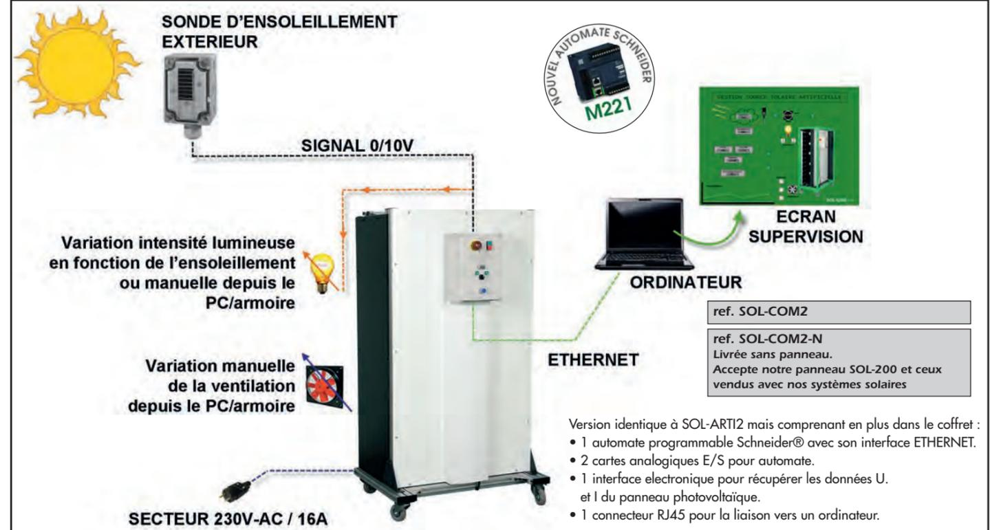
Variation intensité lumineuse en fonction de l'ensoleillement ou manuelle depuis le PC/armoire
