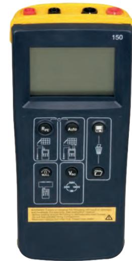
Le pack SOLAR-150 permet de contrôler la sécurité électrique et les performances des installations photovoltaïques. Sûr et facile à utiliser, il combine de nombreuses fonctions.
