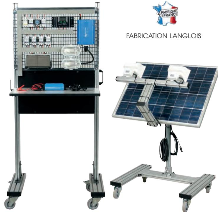
Maquette + Source solaire (panneau et spots) pour un fonctionnement intérieur
