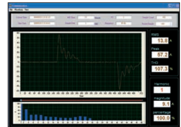
Courant pic - THD - Spectre des harmoniques
