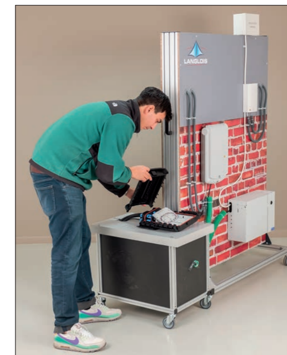
Accès aisé au BPEO de rue situé sous une trappe dans un boîtier technique simulant un regard télécom.
