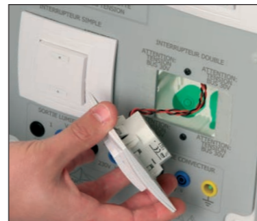
Les boutons poussoirs sont très facilement amovibles sans outils afin de faciliter l'accès aux boutons de programmation.
