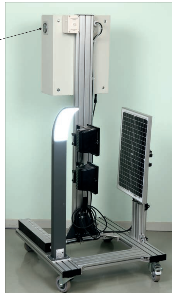
Panneau monocristallin 30Wc pivotant et orientable pour utilisation intérieure avec les 2 projecteurs fournis, extérieure avec une source solaire naturelle.
