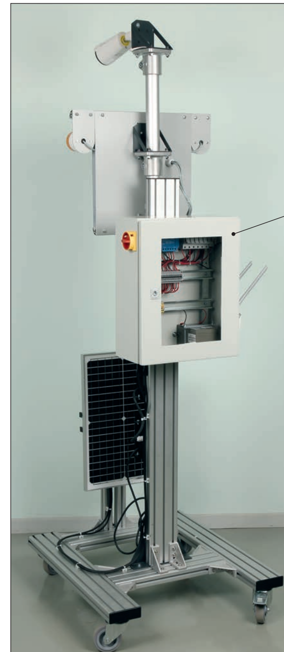
Panneau monocristallin 30Wc pivotant et orientable pour utilisation intérieure avec les 2 projecteurs fournis, extérieure avec une source solaire naturelle.
