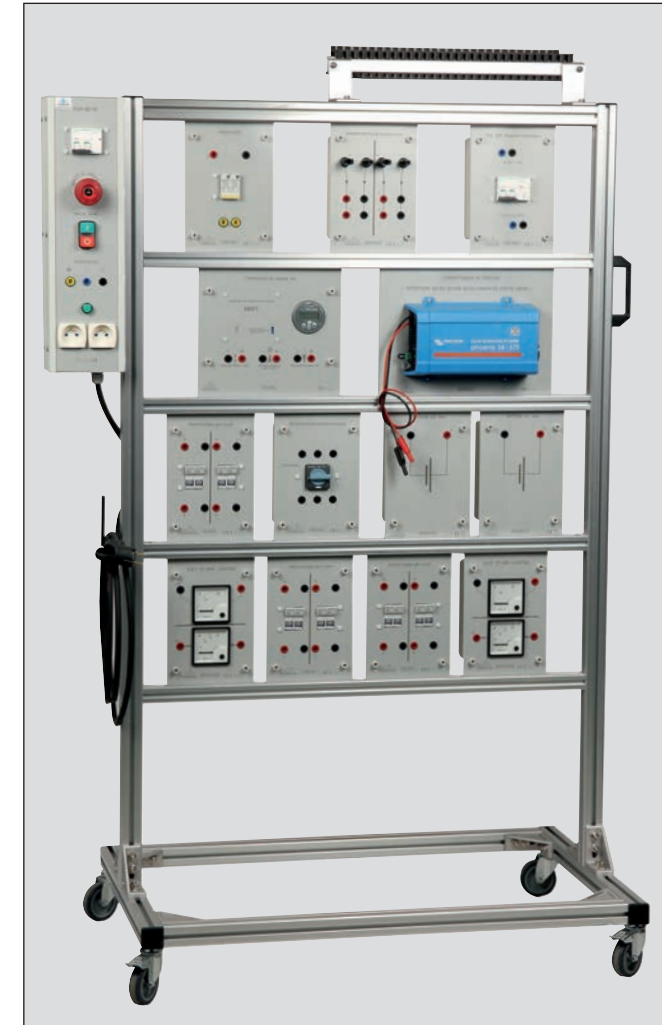
QUICK-NPLUS est un ensemble de modules (H-250mm) photovoltaïques et de panneaux solaires pour l'étude d'une installation solaire sur site isolé.
