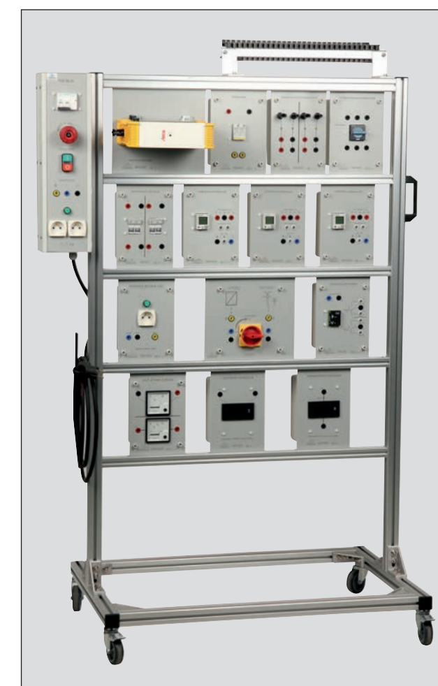
Ensemble de modules (H-250mm) photovoltaïques et de panneaux solaires pour l'étude d'une installation solaire avec restitution de l'énergie sur le réseau 230VAC.
