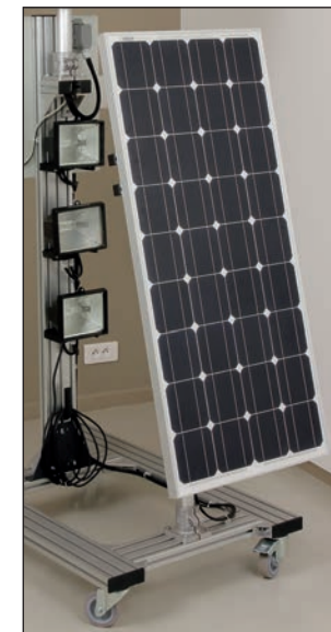
Panneau monocristallin de 90Wc pivotant et orientable pour utilisation intérieure avec les 3 projecteurs fournis, extérieure avec une source solaire naturelle.
