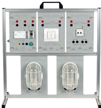
Etude de la commande d'éclairage par bouton poussoir
