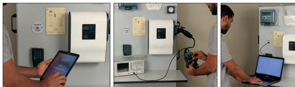
La borne de recharge communique en Wifi ou Bluetooth. Clavier à code avec badges RFID fournis. Prise déportée pour connexion du PC pour la programmation du clavier. Paramétrage du clavier via logiciel fourni
