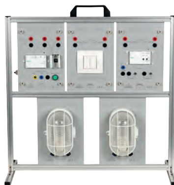
Etude de la commande de variation d'éclairage par bouton poussoir
