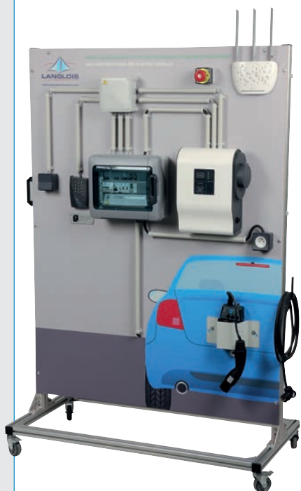
La borne de recharge communique en Wifi ou Bluetooth. Clavier à code avec badges RFID fournis. Prise déportée pour connexion du PC pour la programmation du clavier. Paramétrage du clavier via logiciel fourni
