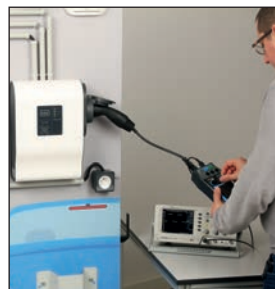
La borne de recharge communique en Wifi ou Bluetooth. Clavier à code avec badges RFID fournis. Prise déportée pour connexion du PC pour la programmation du clavier. Paramétrage du clavier via logiciel fourni
