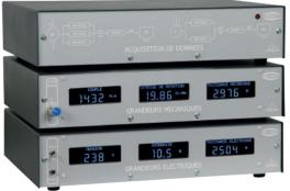
EXAMPLE OF COMPLETE ACQUISITION SOLUTION FOR AC MACHINES STUDY
