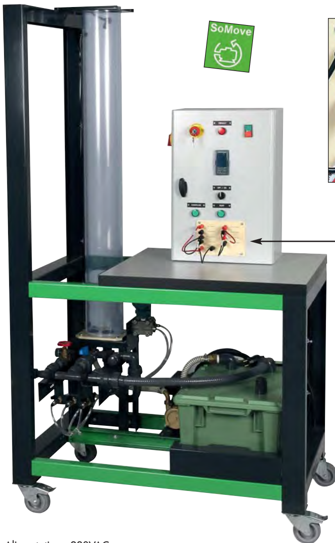
Bornier regroupant les entrées et sorties des capteurs PID et commande variateur
