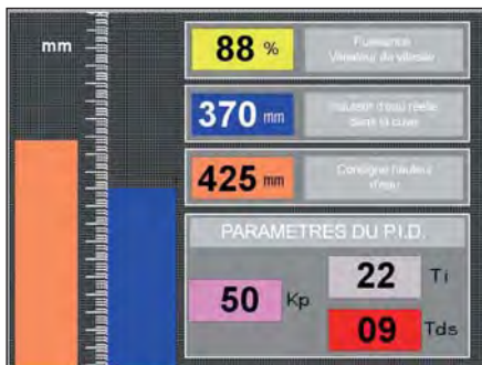
Exemple de supervision sur l'écran tactile
