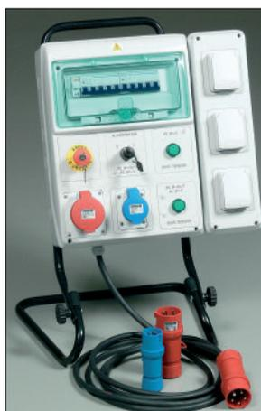
Ce coffret plastique d'une dimension de 460 x 480 x 120mm (hors support) se pose au sol. Il délivre différentes sources de tensions, protégées par disjoncteurs magnétothermiques. Raccordement au réseau 3x400V +N + T par cordon longueur 5 mètres et prise 2P+T. Livré avec fiches mâles pour départs vers cellule.
