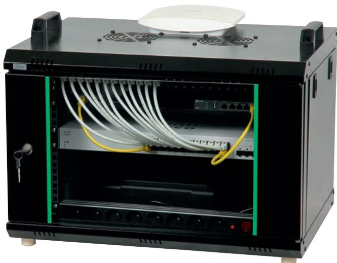
Baie permettant de simuler le réseau informatique d'une petite entreprise. Elle permet la formation sur les techniques de déploiement des infrastructures de réseaux en fonction d'un cahier des charges client et d'appliquer les notions d'administration réseaux et de cybersécurité.
