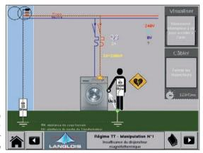
Exemple d'écran Essai en régime TT : insuffisance du disjoncteur magnétothermiau
