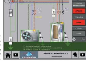
Exemple d'écran Essai en régime IT : visualisation des courants de défaut. L'élève peut relever les tensions sur la face avant de l'armoire
