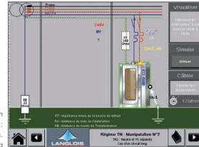
Exemple d'écran Essai en régime TN : neutre et PE séparés
