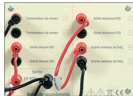
Bornier regroupant les entrées et sorties des capteurs PID et commande variateur
