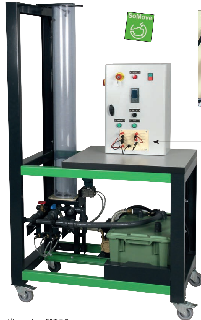
Bornier regroupant les entrées et sorties des capteurs PID et commande variateur
