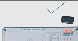
Dans le coin supérieur droit sous un capot verrouillé par le professeur, un interrupteur à 8 switches permet de simuler des défauts.
