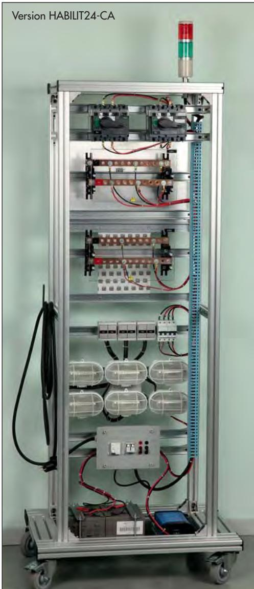
La tension de service de 24VDC protégée par fusible et disjoncteur, rend l'utilisation de l'armoire entièrement sécurisée. La charge intégrée, composée de 6 lampes de 60W, permet de générer une intensité suffisamment significative. L'armoire est autonome et ne nécessite aucune liaison au secteur 230V lors de son utilisation. Un câble secteur est toutefois intégré afin de recharger les batteries via un chargeur intégré. Existe en 3 versions, fixe ou mobile.
