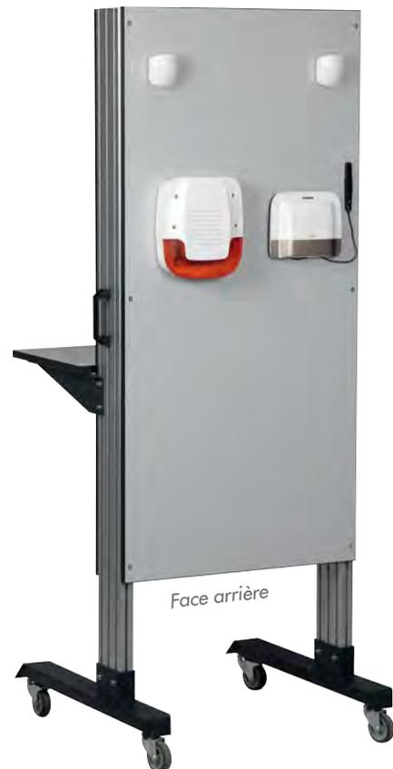
Panneau d'étude et de programmation d'une centrale d'alarme anti-intrusion sans fil avec sirène. La centrale est équipée de 4 détecteurs passif infrarouge, d'un détecteur magnétique déclenché par l'ouverture de la fenêtre. A distance, le clavier à code met l'alarme sous ou hors surveillance. Un transmetteur GSM signale tout déclenchement de l'alarme sur un téléphone mobile (non livré). La centrale peut-être commandée par les 2 télécommandes.
